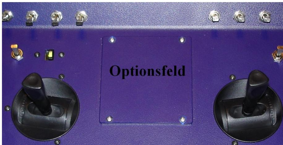
Das Optionsfeld bietet die Möglichkeit zur Montage weiterer Bedienelemente. Dies können zusätzliche Schalter aber auch Dreh- oder Linearpotis sein. Es ist ebenso möglich weitere Kreuzbedienelemente einzubauen.
