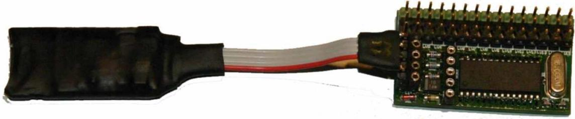
Dies ist ein 15er Auswertemodul mit dem 20 Meter HF Modul. Das HF Modul darf nur in der hier gezeigten Form auf das Auswertemodul gesteckt werden<sup>5</sup>.
