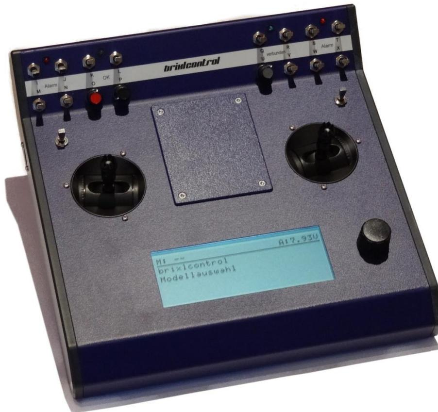
Dieses Bild zeigt den brixlcontrol Sender in der Grundausstattung. Diese besteht aus zwei Kreuzknüppeln, einem Digisteller, drei Drehpoti ohne Mittelstellung sowie 15 Schaltelementen.
